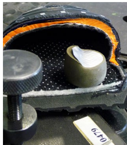
Zehenschutzkappen und Prüfkörper nach der Druckprüfung
