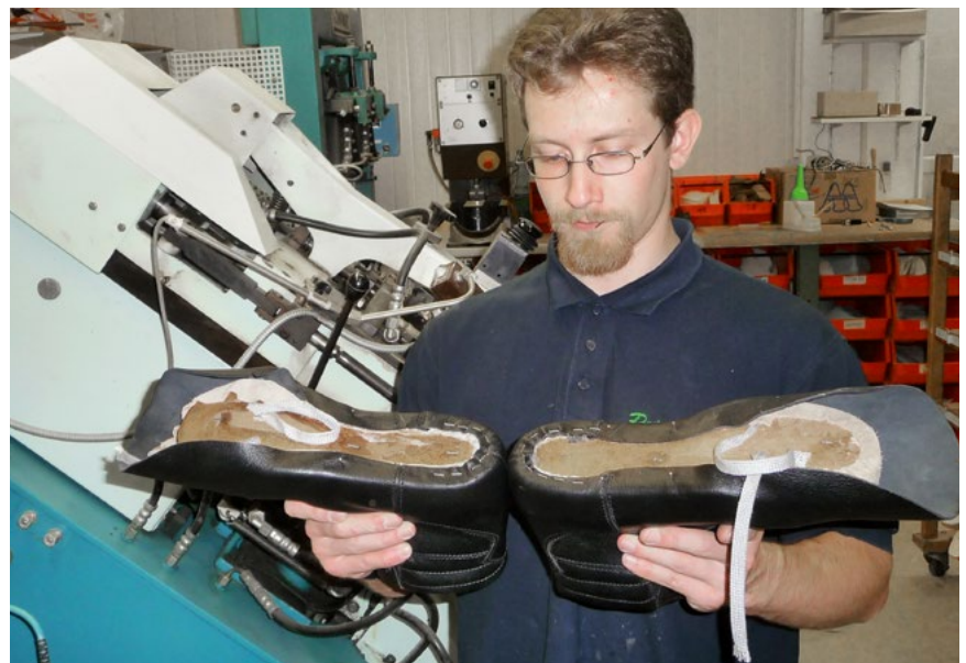
Die Herstellung orthopädischer Sicherheitsschuhe erfordert hohe Qualitätsstandards. Hier prüft der Orthopädienschuhmacher den korrekten Sitz des Schaftes auf dem Leisten.
